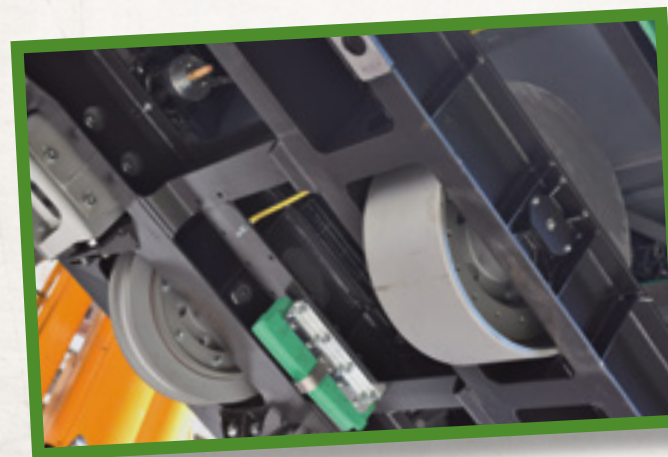
Les rodes del funicular sistema Abt. Foto Joan C. Salmerón (2020).
