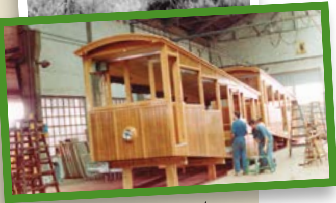
Construcció de les noves carrosseries de fusta als tallers de Martorell Enllaç. Arxiu FGC (1982).
