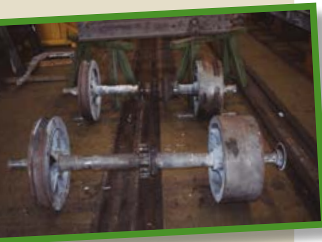
Les rodes dels funiculars disposen d'un curiós sistema de doble pestanya que permet simplificar els creuaments. Foto Joan C. Salmerón (2017).
