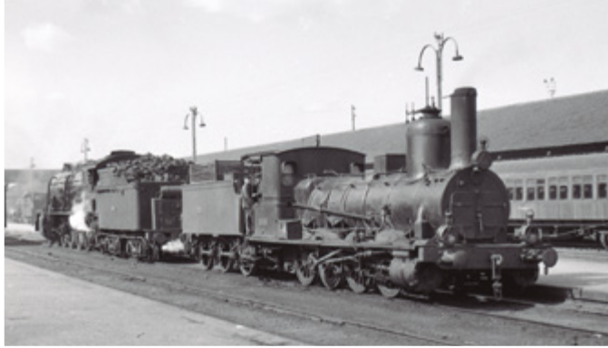
Locomotora de vapor 040 (sèrie Renfe 040-2091 a 2127) (ex sèrie Norte 501 a 537 y 2501 a 2537). Foto: AHF (Carlos Diego Marquand Wyrsh-Cüyer) (1959)
