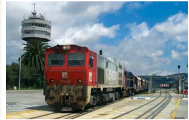
L'entrada ferroviària al Port de Barcelona es realitza a través d'una curiosa via de quatre carrils. Foto Joan C. Salmerón (2014).
