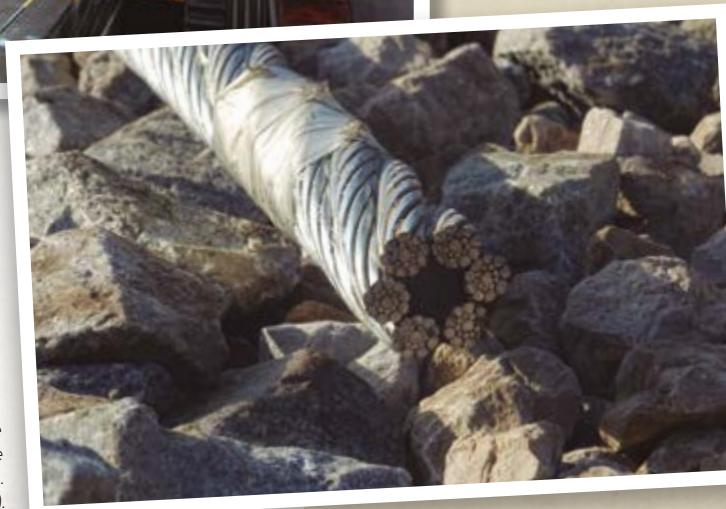
*El cable del Funicular de Gelida es una de las piezas clave del funcionamiento de esta instalación de transporte por cable. Foto Joan C. Salmerón (2019).*
